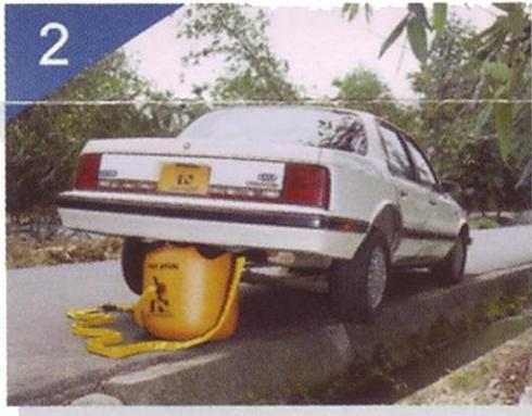
2. Schließen Sie das Endstück des Schlauches an den Air Jack an. Überprüfen Sie, ob das Kuppelstück sicher mit dem Luftsack verbunden ist. Stülpen Sie die Aufstecktülle auf den Auspuff.
