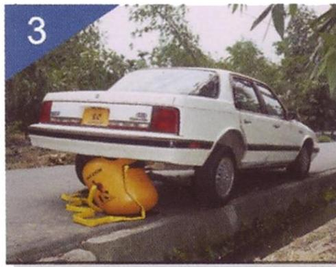
3. Starten Sie den Motor und füllen Sie den Air Jack, bis die gewünschte Höhe erreicht ist. Entfernen Sie nun die Aufstecktülle vom Auspuff.
